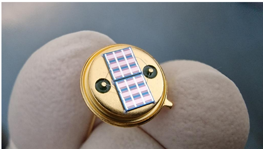
Abbildung 1: Infrarot-Emitter-Array für Thermische Strahlung zwischen 2 bis 15 \mu\text{m} bis 100 Hz. © CiS
