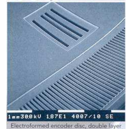
1mm300kU 1.97E1 4009/10 SE Etched encoder disc
